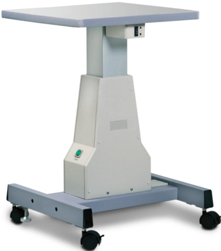
ATE-300 est une table pour instrument ophtalmologique avec une colonne centrale et une base stable permettant un accès aux fauteuils roulants. Le plateau est disponible en blanc ou gris avec une finition bois sur les côtés. Le débattement est de 300 mm et peut être contrôlé par un panneau de contrôle facile d'accès.
